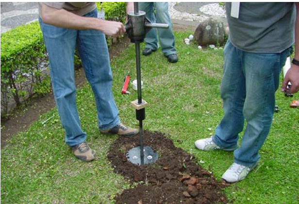
Figura 2. Execução do ensaio DPL
