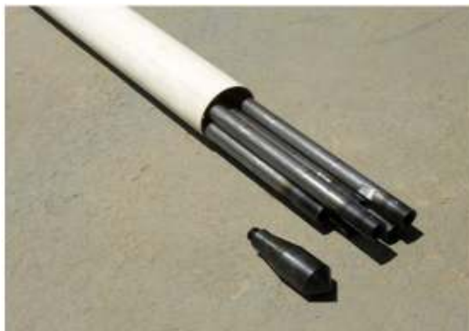
Figura 3: Detalhe das hastes e ponteira do DPL.
