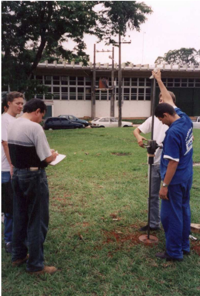
Fig 2: Execução de DPL NILSSON na UnB, Brasília.
